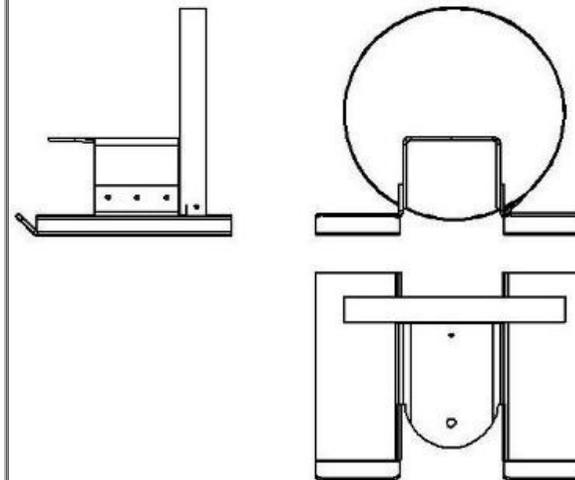
L'objet est représenté selon plusieurs vues dont la disposition respecte des règles précises. C'est la **projection orthogonale**. La représentation est fidèle à ce que l'on voit
