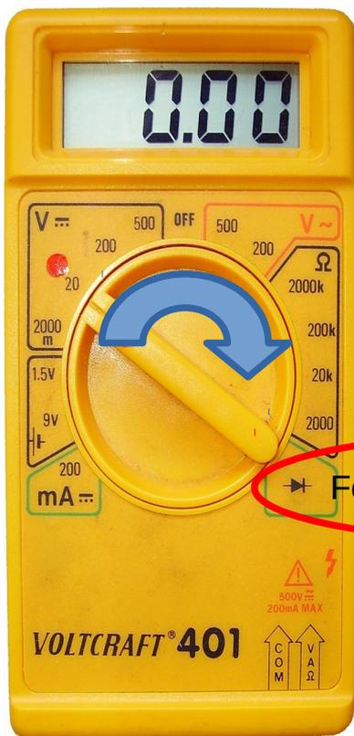
Cet instrument est un **multimètre** avec lequel vous pouvez mesurer l'intensité d'un courant, une tension ou une résistance. On peut aussi l'utiliser en testeur de continuité.
